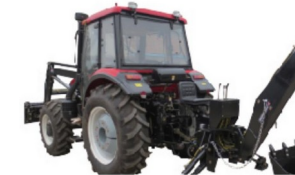
后置挖掘机 Backhoe
